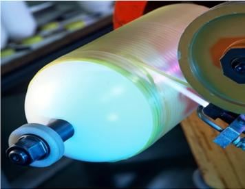
Fabrication d'une pièce par enroulement filamentaire. © EADS Composites Aquitaine
