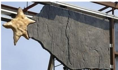
Imitation d'un bloc d'ardoise réalisée en matériau composite © CRITT Matériau
